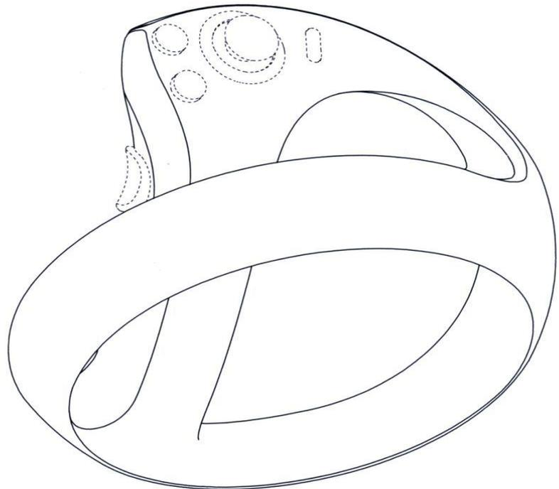
El componente inferior de la parte trasera en forma de l está curvado hacia adelante y se une en su extremo a la parte inferior de la superficie lateral interna de la parte delantera
