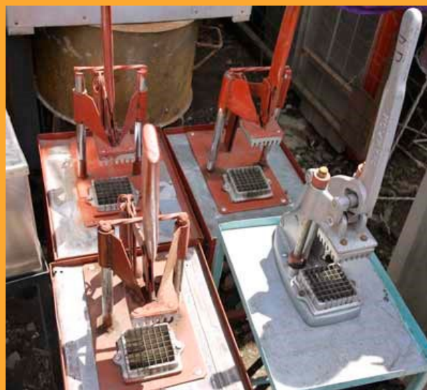
Máquinas para cortar patatas. Modelo importando (derecha). Una adaptación informal utiliza metal laminado en lugar de aluminio e incorpora un mecanismo de retorno a la posición inicial mediante resortes. En la economía informal, la innovación suele obedecer a necesidades de adaptación (Foto: © C. Bull).
